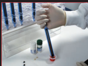
Fig. 8 | Faire couler le photoréactif dans les Chambres Test
