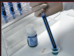
Fig. 6 | Faire couler l'anticorps dans les Chambres Test
