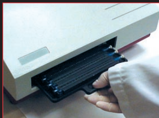
Fig. 9 | Charger la cassette dans le Luminomètre
