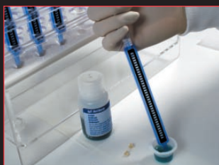
Fig. 6 | Aspirare l'anticorpo nelle camere test
