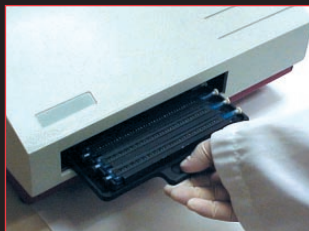
Fig. 9 | Caricare il vassoio del caricatore nel luminometro
