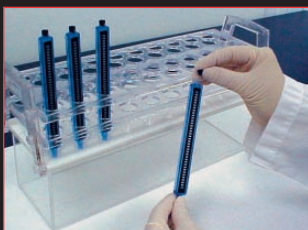
Fig. 4 | Taponamiento de las cámaras de prueba
