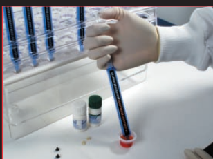
Fig. 8 | Introducción del fotorreactivo en las cámaras de prueba
