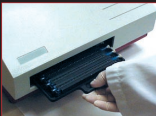
Fig. 9 | Carga de la bandeja del chasis de alojamiento en el luminómetro
